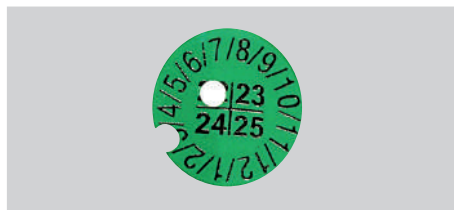
Kalibrační značka pracovního měřidla, na které je vyznačen měsíc a rok příští kalibrace.
