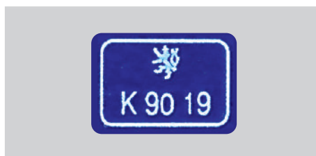
Kalibrační značka pracovního měřidla, na které je vyznačen měsíc a rok příští kalibrace.
