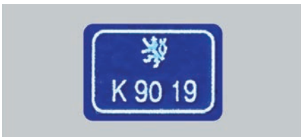
Úřední značka stanoveného měřidla vydaná autorizovaným metrologickým střediskem K130 – poslední dvojčíslí znamená rok, ve kterém bylo provedeno ověření měřidla. Například u tonometru je lhůta dva roky.
