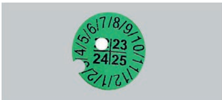
Kalibrační značka pracovního měřidla, na které je vyznačen měsíc a rok příští kalibrace.
